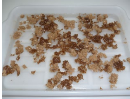
油を吸ったものが焦げ茶色に変色 油量に対してエコツナーが多過ぎる例
