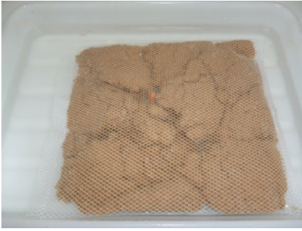
投入直後 完全に水に浮いている
