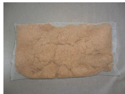
ネット内いっばいに広げて 残渣カゴ下や第2槽などに投入する。 この1個で約1kgの油を吸着します。
