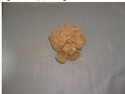
掴んで取出した団子状態のままで 油の上に投入しても吸着効率が悪い。
