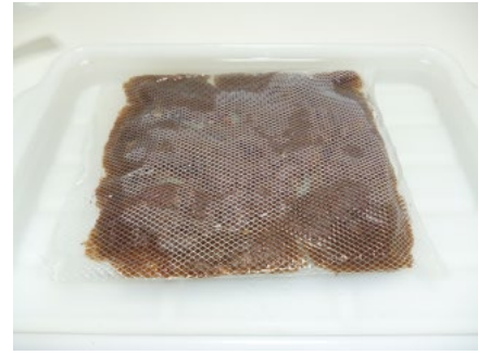
全体が変色し吸着限界に達した状態 水に2/3程度沈んでいる 新品のエコツナーに交換が必要
