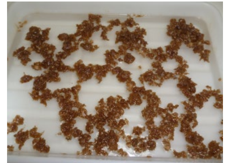
ほぼ全部が油を吸着した状態 油量に対してエコツナーが適量の例
