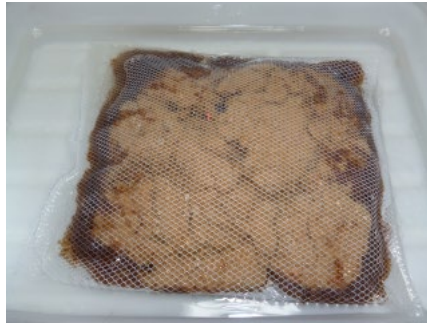
半分程度油を吸った状態 焦げ茶色の部分が油を吸った部分 まだ吸着余地があり裏返して使用可能
